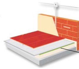
Przekrój strukturalny ogrzewanej podłogi panelowej z zainstalowaną matą grzejną
